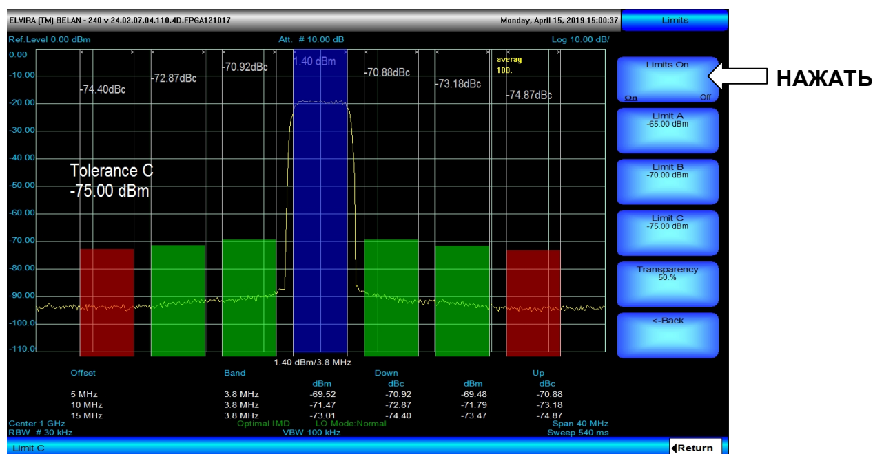
Рис. 65. Дополнительное меню для редактирования пороговых значений мощности в соседних каналах
