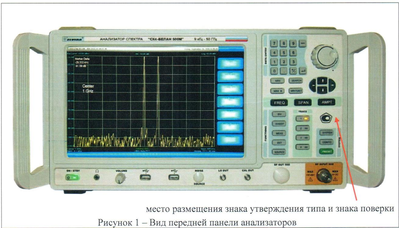
Рисунок 1 – Вид передней панели анализаторов
